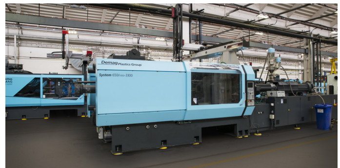
DEMAG, Schließkraft 4 200 – 6 500 kN
