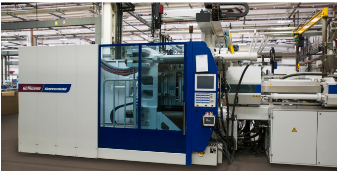
BATTENFELD, Schließkraft 6 000 – 8 000 kN
