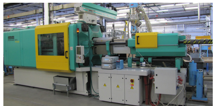
ARBURG, Schließkraft 4 600 kN
